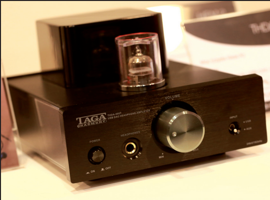
Taga Harmony développe également des électroniques à tubes comme cet excellent ampli casque en triode à simple étage.
